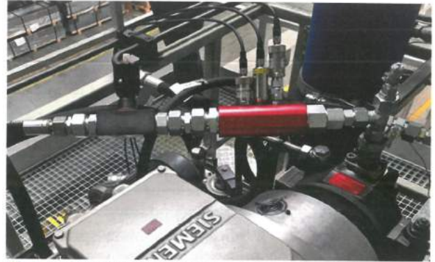
Rys. 2. Zestaw czujników pomiarowych, zabudowanych na linii tłocznej badanej pompy
