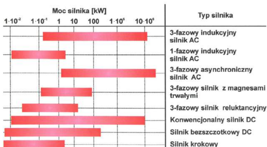
Rys. 1. Zakresy mocy uzyskiwanych przez różne konstrukcje silników elektrycznych [1]
