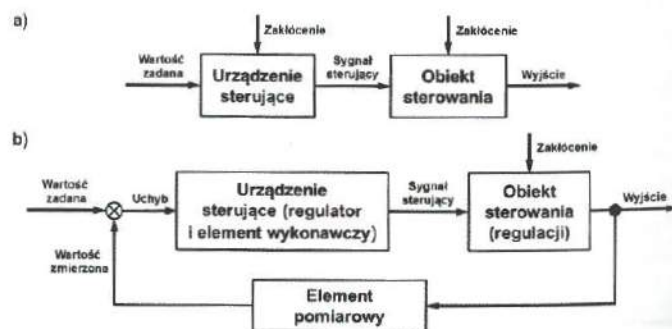
Rys. 1. Schemat blokowy sterowania w układzie: a) otwartym, b) zamkniętym [2]
