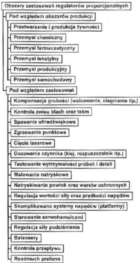
Rys. 3. Zastosowanie regulatorów w pneumatyce oraz elektropneumatyce
